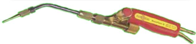
Легкая и удобная горелка с хорошей эргономикой. Кислородно-Ацетиленовая горелка оснащенная 5-ю сменными соплами с производительностью 100, 160, 250, 315 и 400 литров в час. Длина 320мм. Вес 350гр.
